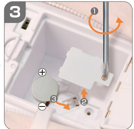
コイン形電池カバーのネジを+ドライバーで取り外し、+の向きに注意して新しいコイン形電池をセットしてください。
