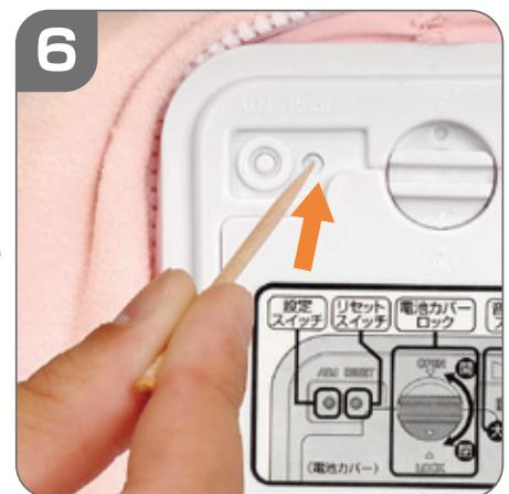
②電池カバー上部にある【リセットスイッチ】を、ペン先など、先の細い棒で押してください。
